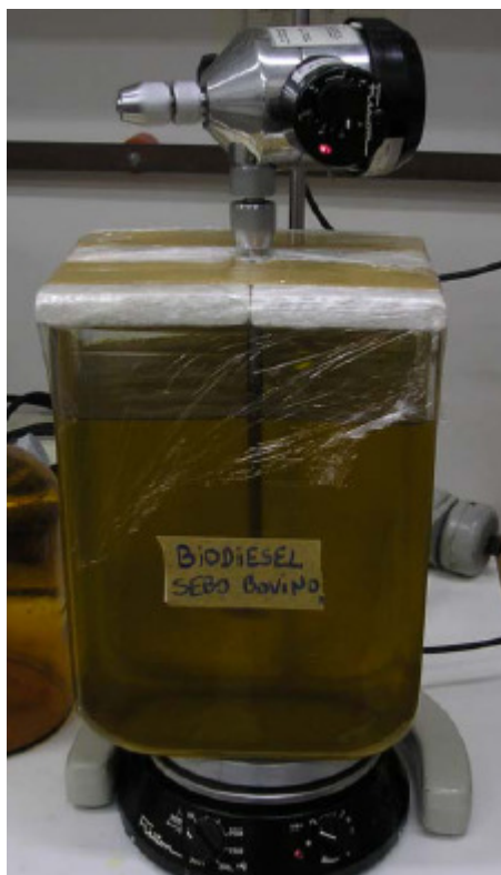
Fig. 8: Biodiesel de sebo transesterificado com etanol sendo agitado
