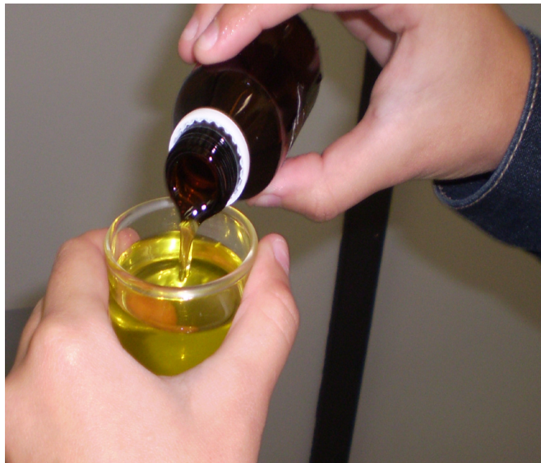
Fig. 23: Amostra de biodiesel de sebo bovino sendo posta no “cadinho”.
