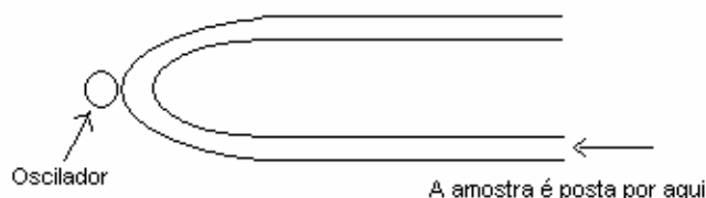
Fig. 12: tubo em U do Densímetro Digital
