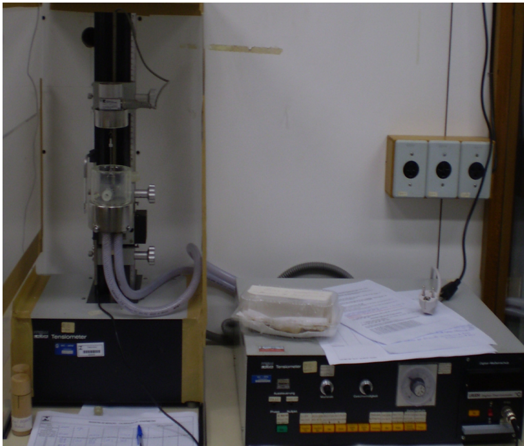
Fig. 20: Tensiômetro Lauda TE-1, utilizado no estudo.
