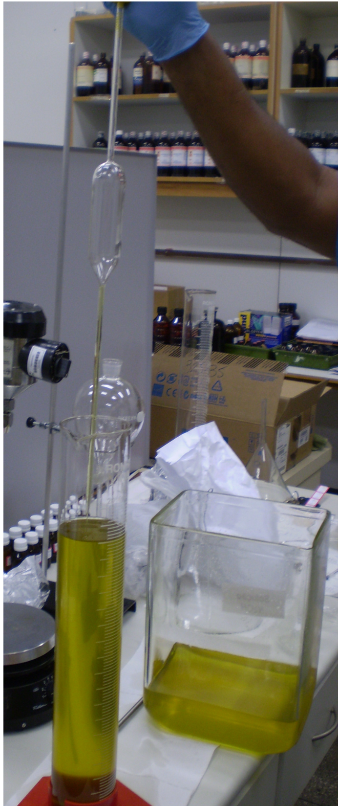
Figura A.VI.3: ajustando o menisco na proveta
