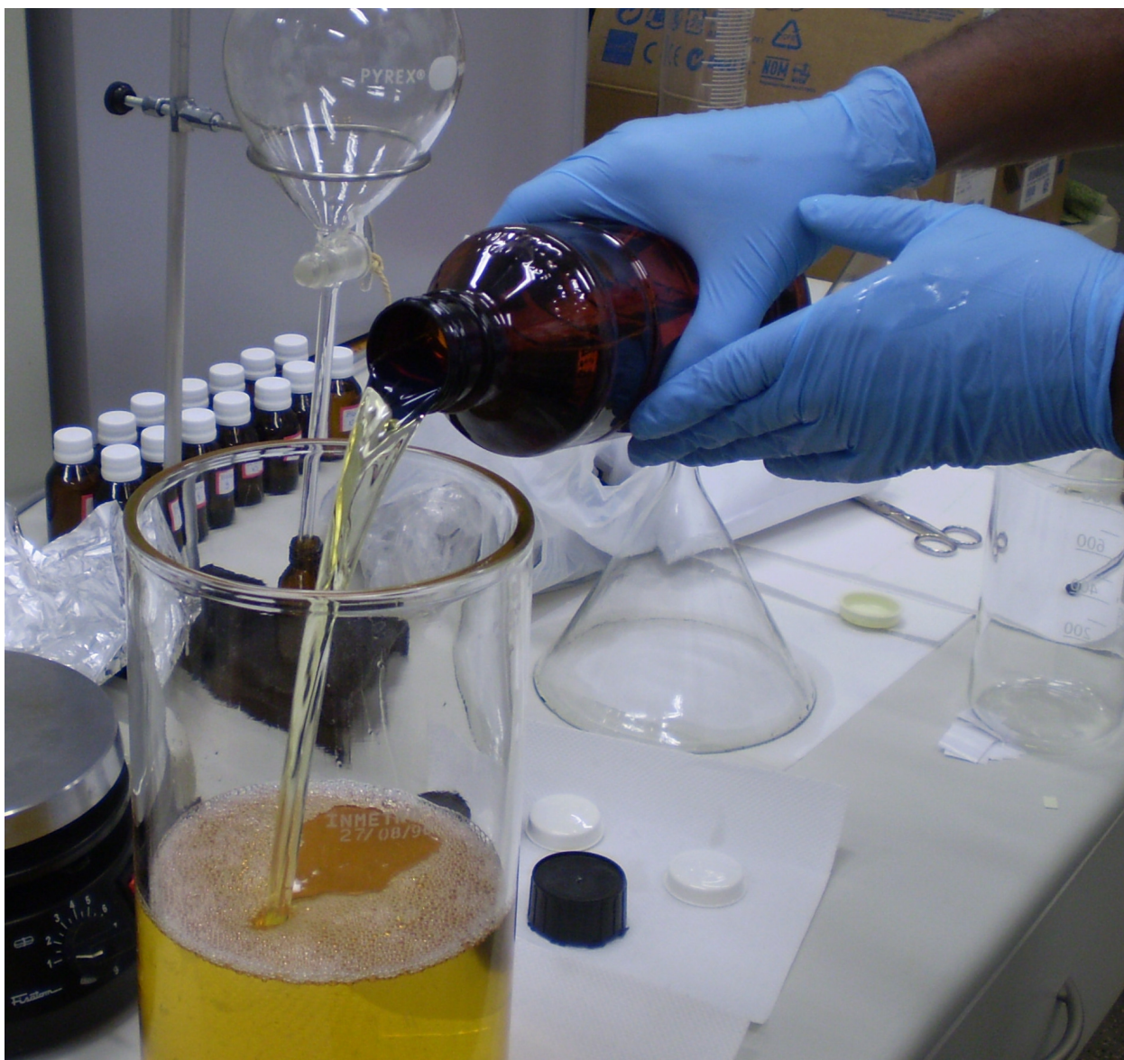
Figura A.VI.1: óleo diesel sendo posto na cuba
