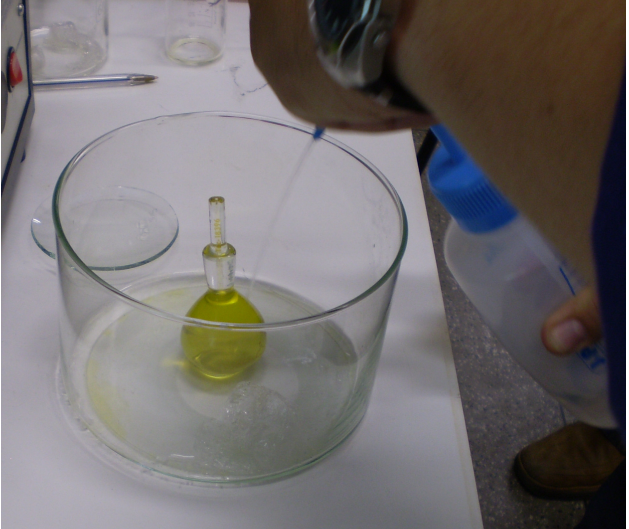
Fig. A.I.6: Picnômetro sem o plástico, com tampa e sendo resfriado.
