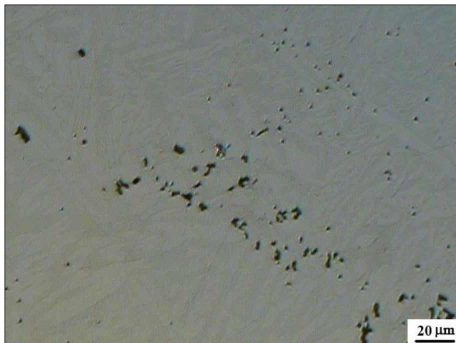
Fig 60 – Microestrutura com a presença de fase sigma do eletrodo Böhler Solubilizado 1050°C. Ataque: 10% KOH, 3V, 15s.
