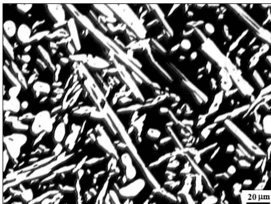
Fig 57 – Microestrutura do eletrodo Böhler. Solubilizado 1150°C. Ataque: Beraha.
