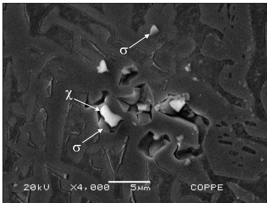
Fig 98 – Microscopia eletrônica de varredura do eletrodo Böhler solubilizado a 1050°C apresentando pequenas quantidades de fase deletéria. Ataque: 10% NaOH.
