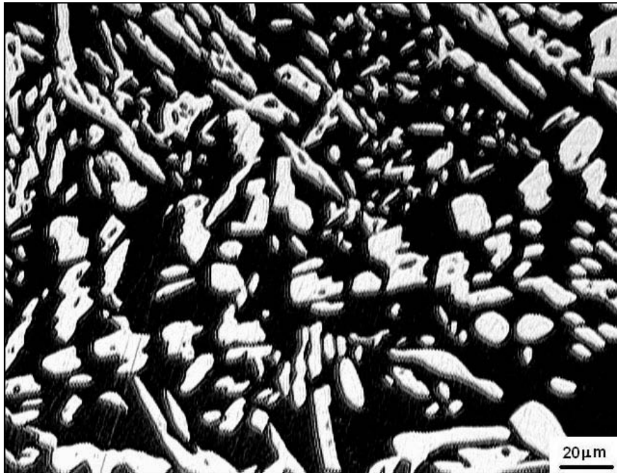
Fig 73 – Microestrutura da raiz-Sandvik. Solubilizada a 1150°C. Ataque: Beraha.
