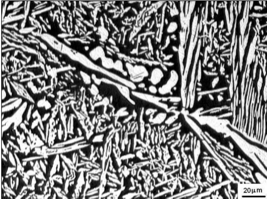
Fig 55 – Microestrutura do eletrodo Sandvik. Solubilizado 1050°C. Ataque: Beraha.
