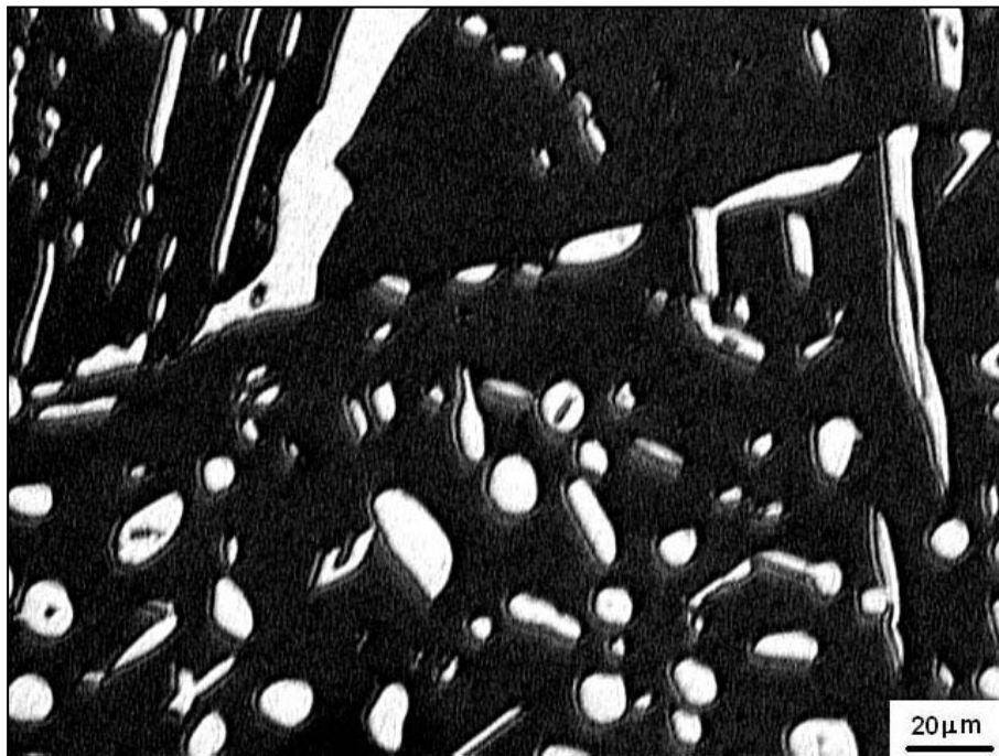
Fig 74 – Microestrutura da raiz-Kestra. Solubilizada a 1150°C. Ataque: Beraha.
