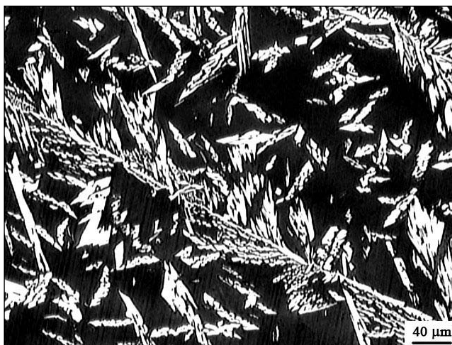
Fig 51 – Microestrutura do eletrodo Böhler. Fundido. Ataque: Beraha.
