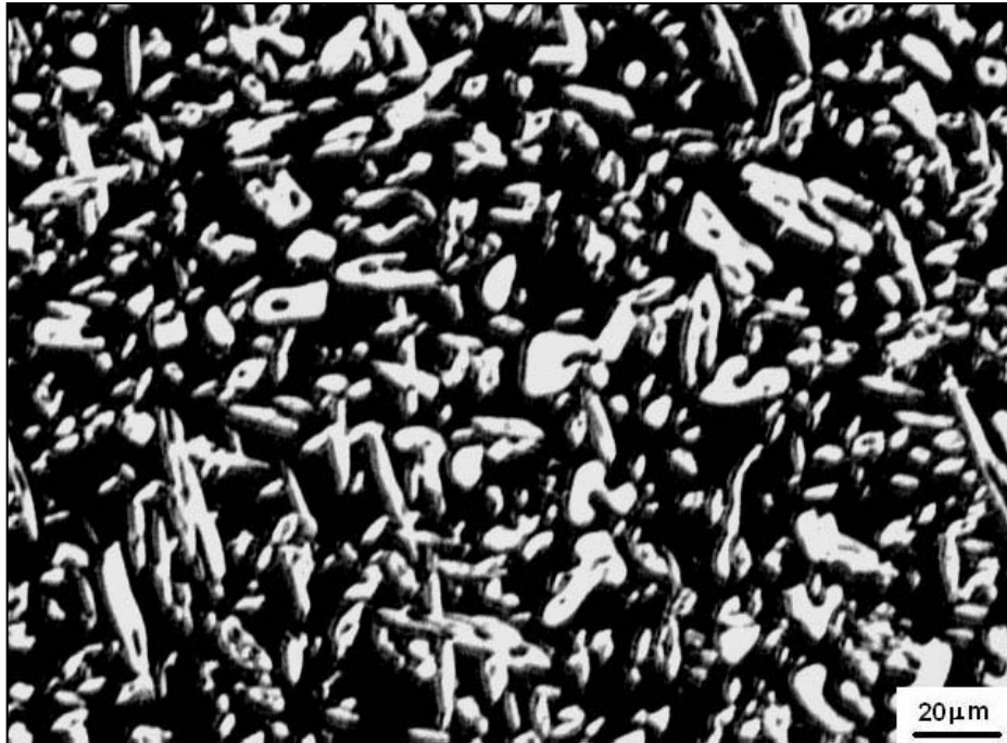
Fig 71 – Microestrutura da raiz-Kestra. Solubilizada a 1050°C. Ataque: Beraha.
