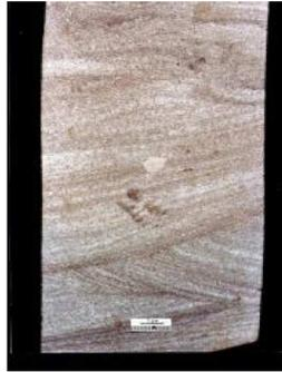
**Figura 1.1** Parte de um testemunho de rocha extraído de um poço de exploração de petróleo, utilizado para análise macroscópica.
