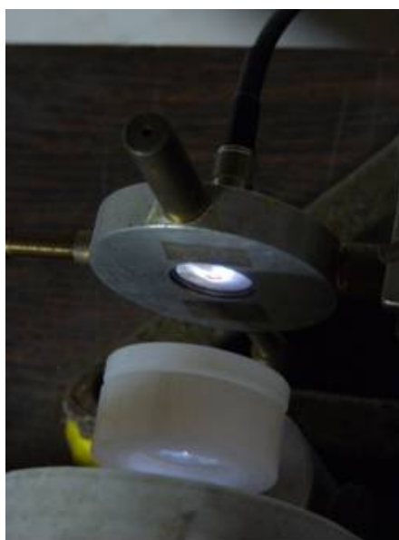
Figura 38 - Saída da luz, passo pela lente convergente e ingresso a fibra óptica.
