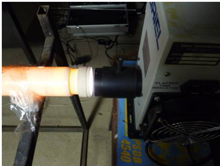
Figura 37 - Ingresso de luz na tubulação de estocagem.
