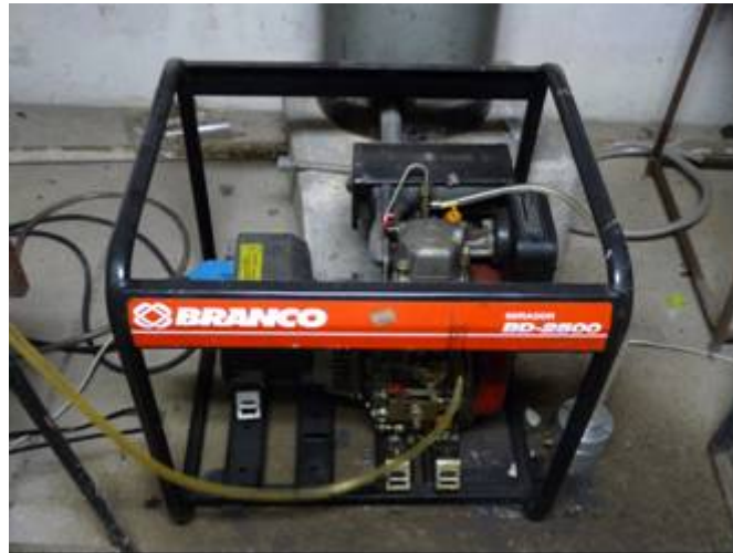
Figura 33 - Motor gerador Branco BD 2500
