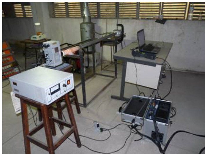
Figura 40 - Distribuição dos equipamentos utilizados na análise dos gases de exaustão. Em sequência do percurso da luz: Fonte de corrente Oriel e lâmpada de arco Xenônio Oriel; Tubulação de estocagem; Atrás tanque chaminé e mangueira de conexão. À direita, mesa com equipamentos da figura anterior.
