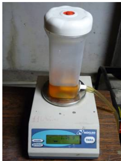
Figura 30 - Tanque de combustível e balança para medição do consumo de combustível
