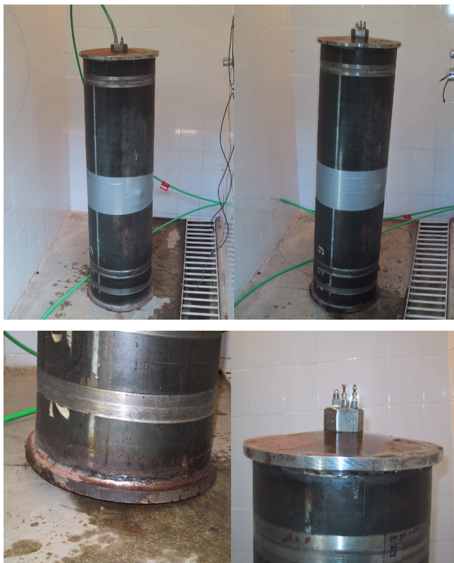
Figura 4.15 – Tampas soldadas deformadas após ensaio a 60 \text{ kg/cm}^2 e 80^\circ\text{C} .
